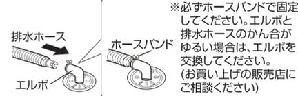
《排水口にエルボがない場合》排水ホースの先端を排水口に差し込みます。
