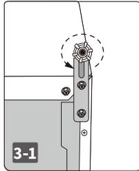
3-1 下部右側、調整脚(小)を回して外します。
