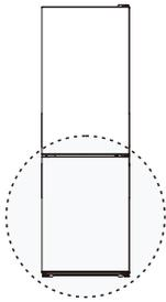
中央部のヒンジ、及び下部ドアを取り外します (上図の点線部)
