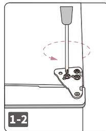
プラスドライバーを使って3本のネジを外し、上部ヒンジを取り外します。
