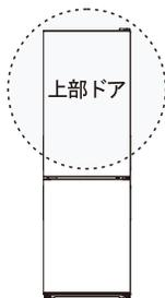
上部ドアを取り外します(上図の点線部)。
