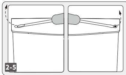
ドア上部左側のキャップと、右側のヒンジ穴をマイナスドライバーを使って取り外し、左右位置を入れ替えて取り付けます。
