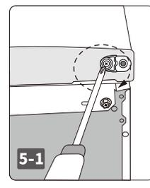
5-1 プラスドライバーを使って、下部ドア底面右側のヒンジ受けを外します。
