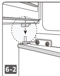
中央部ヒンジと、上部ドア下ヒンジ受けの凹凸を合わせます。
