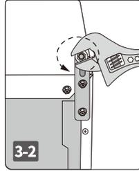
3-2 スパナを使って調整脚の軸を外します
