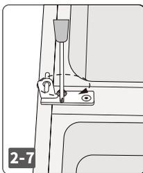
中央左側に中央部ヒンジを当て、プラスドライバーを使って2本のネジで取り付けます。
