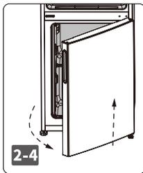
ドアを少し開けた状態で、上方向に持ち上げるようにして取り外します。
