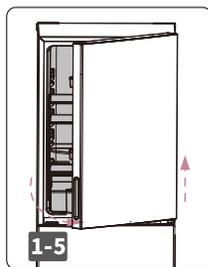
ドアを少し開けた状態で、上方方向に持ち上げるようにしてとりはずします。
