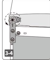
3-4 下部左側、調整脚(大)を回して外します。
