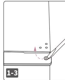
マイナスドライバーを使って、ヒンジ穴カバーを外します。
