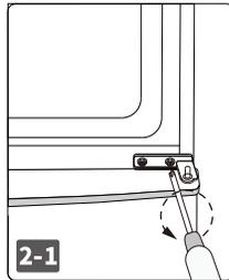
プラスドライバーを使って中央部右側、2本のネジを外します。
