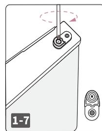
上部ドア底面左側にヒンジ受けを取り付けます。
