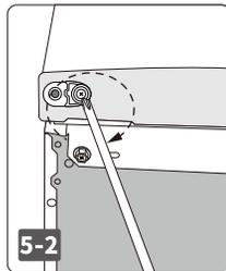
5-2 プラスドライバーを使って、下部ドア底面左側にヒンジ受けを取り付けます。
