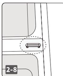
中央右側に2個のキャップ (小) とネジカバーを取り付けます。
