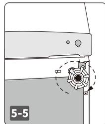
5-5 下部右側に調整脚(大)を回して取り付けます。
