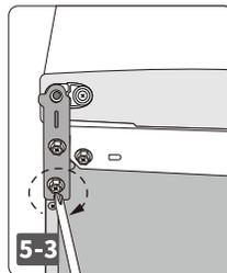
5-3 下部左側にプラスドライバーを使って2本のネジを締め、下部ヒンジを取り付けます。
