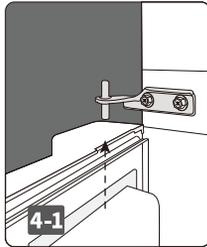
4-1 中央部ヒンジとドア側ヒンジ穴の凹凸を合わせます。
