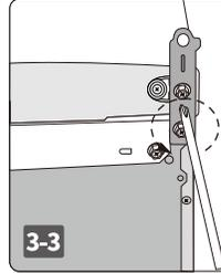
3-3 プラスドライバーでネジを2本外し、下部ヒンジを外します。
