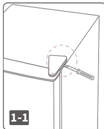
マイナスドライバーを上図の囲い部に差し込み、ヒンジカバーを持ち上げて外します。
