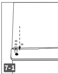
上部左側、ヒンジ穴カバーを差し込みます。
