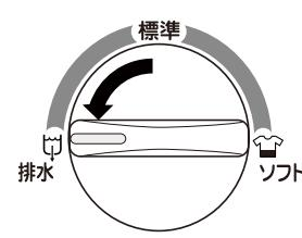
水流/排水切換を「排水」に合わせ排水します。
