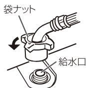
6 袋ナットを傾きないように確実に締め付ける
