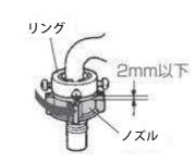
洗濯前に水栓を開き、給水ホース接続部のゆるみや水漏れのないことを確認する。 ネジやホース接続などがゆるんでいると、水漏れして床などの家屋や家具などをぬらしたり、破損した
