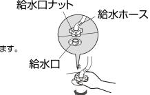
■給水ホース継手への取り付け
