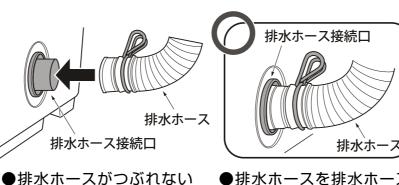
●排水ホースを排水ホース ように取り付けてください。 接続口の根元まで差し込み ます。
