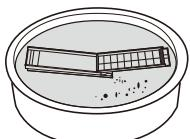
3 糸くずフィルターの下部を槽内の取り付け口に差し込んでから全体を押し込む
