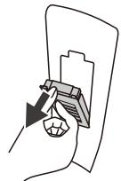
2 糸くずフィルターを開け、ゴミを取り除いてから水中で洗い、閉める
