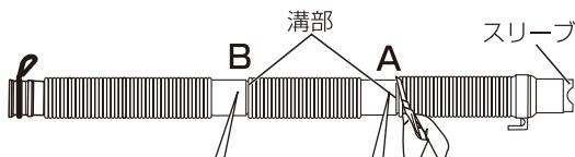
本体と排水口の距離に応じて、溝部2ヶ所A・Bのうち、どちらかの溝部を切って先端にスリーブをはめ直してください。
