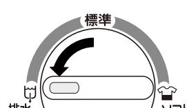
水流/排水切換を「排水」に合わせ排水します。
