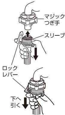
ロックレバーと本体が接触しない位置で取り付けてください。(水もれの恐れ)
