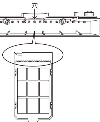
※流水フィルター内部の黒い枠の棟をツメの近くの裏側から指で押してツメから外します。
