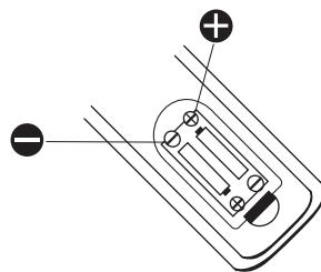
3 矢印部分とは反対側にある電池カバーの小さなツメをリモコン本体側に引っ掛けてから、矢印部分を指で押さえて元どおりに閉めてください。
