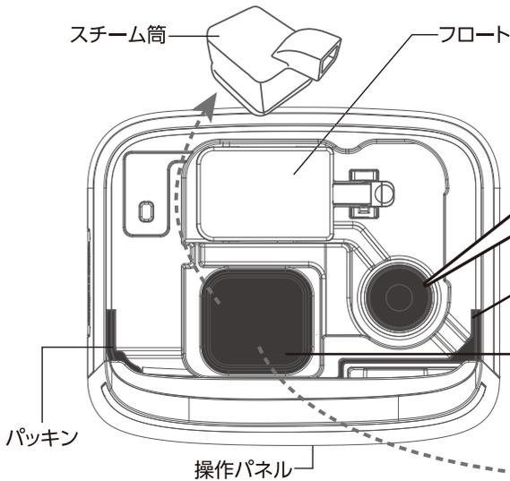
フロート、スチーム筒、タンク裏のフィルタータンクキャップを取り外して清掃してください。
