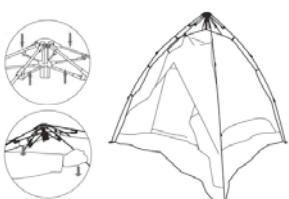
①下部ジョイントを上部ジョイントへスライドさせ、ポールの固定を解除します。
