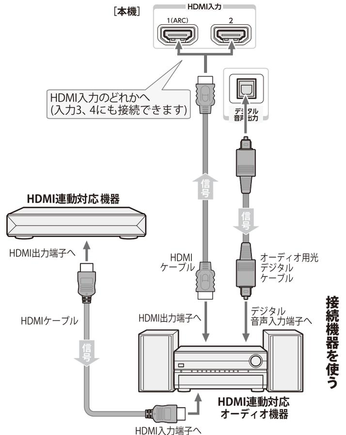
※ ARC対応のオーディオ機器を、ARC対応のHDMIケーブルでHDMI入力1 (ARC) 端子に接続する場合は、デジタル音声ケーブルの接続は不要です。
