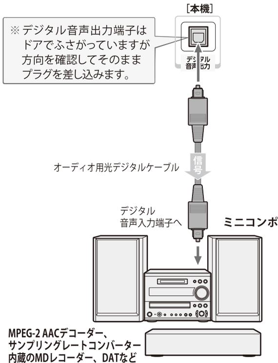
※ デジタル音声ケーブルのプラグには2種類の形状があります。接続する機器の端子形状に合ったケーブルをお願い求めください。本機側に差し込むプラグの形状は、
