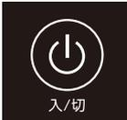
電源入/切ボタンを押すと、ランプが点灯し、運転を開始します。
