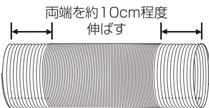
②排気ノズルとダクトエンドを、排気ダクトの伸ばした両端にセットし、両方がある程度固定されるまで右回りに回してセットします。
