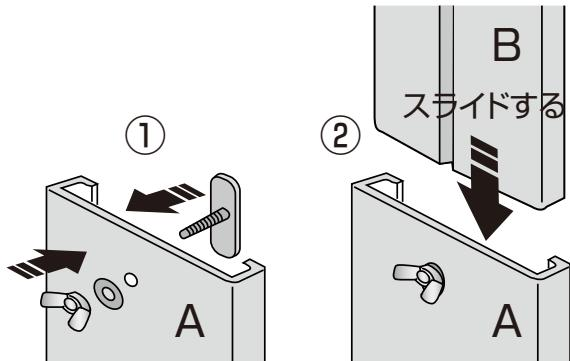
②ダクトパネル B の中央の凸溝に T 型ネジを縦にして差し込み、ダクトパネル A にスライドして重ね、蝶型ナットで仮おさえしておきます。
