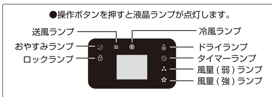
[ 温度 / 時間表示パネル ] ※送風・ドライ運転時は周辺温度、冷風運転時は設定温度が表示されます。(周辺温度は目安です)
