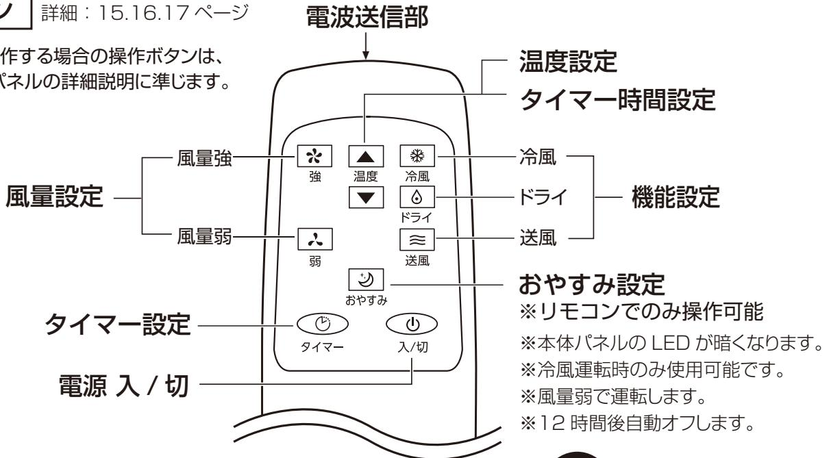
※リモコンを使って本体を操作するときは、リモコンの「電波送信部」を本体の「リモコン電波受信部」に向けて操作ボタンを押してください。
