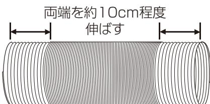
②排気ノズルとダクトエンドを、排気ダクトの伸ばした両端にセットし、両方がある程度固定されるまで右回りに回してセットします。
