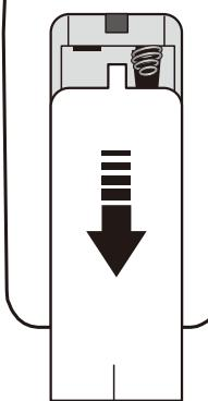
リモコン裏の電池ボックスカバーをスライドして開け、ボックス内の刻印に合わせて市販の単4形アルカリ乾電池を2本セットしてください。
