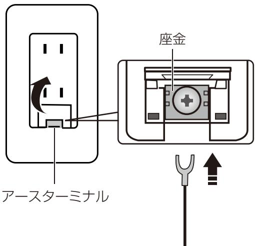
②プラスドライバーでネジを反時計回りに回して緩めます。
