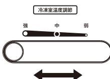
冷凍室と冷蔵室の冷気の配分を調節します。
