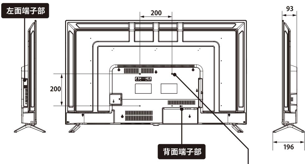
壁掛け用金具取り付けネジ穴
