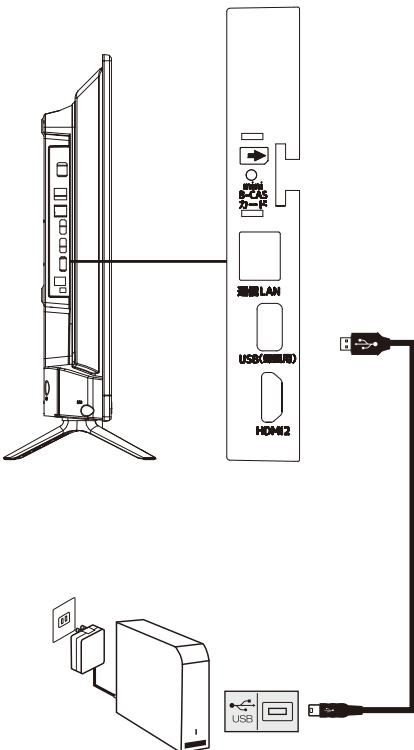
※USB端子からHDD(ハードディスク)の安定動作に十分な電力が供給されておりません。据え置き(AC給電)タイプを推奨します。
