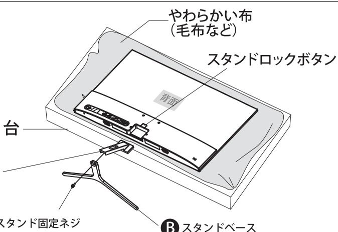
液晶パネルを傷つけないように取り扱ってください。はずしたネジは、再度スタンドを取り付ける場合に必要です。
