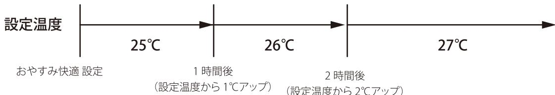
最大設定温度31°Cにした場合は、温度上昇せず31°C運転が続けます。
