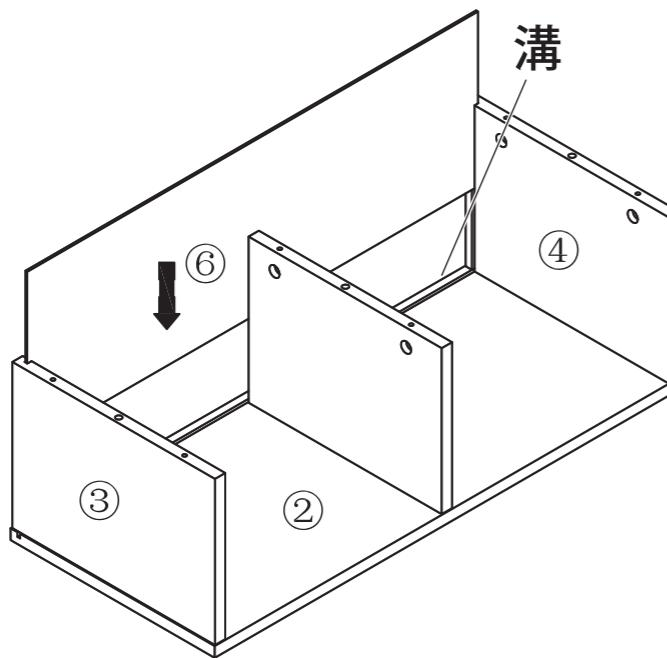
**4** 棚パーティ<sup>②③④⑤⑥</sup>にCを差し込み、①を乗せて③・④・⑤にカムロックAで締めて固定します。
